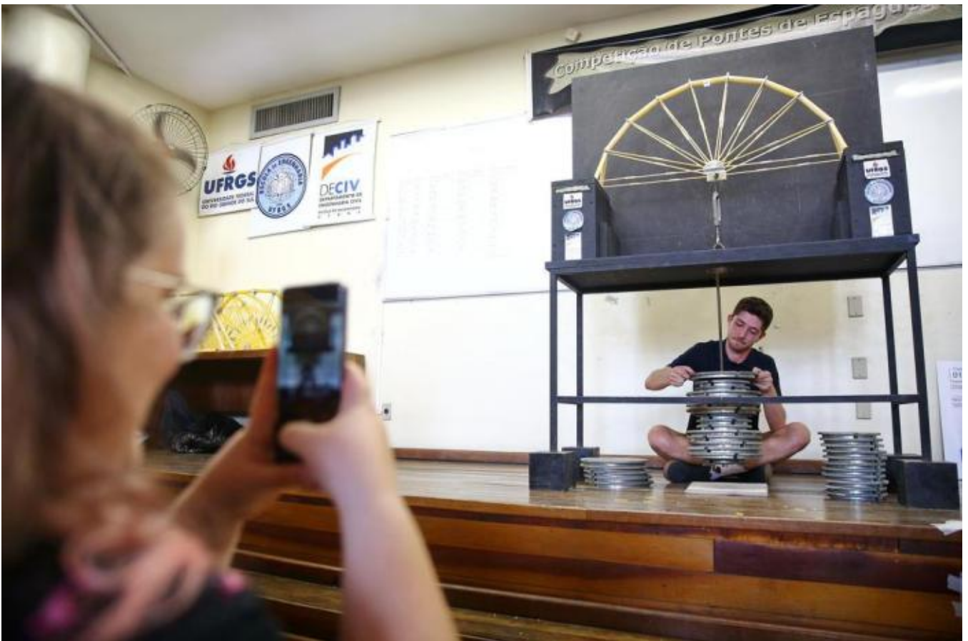
Os próprios alunos colocam pesos na haste para ver quanto a ponte suporta Camila Domingues / Agência RBS
